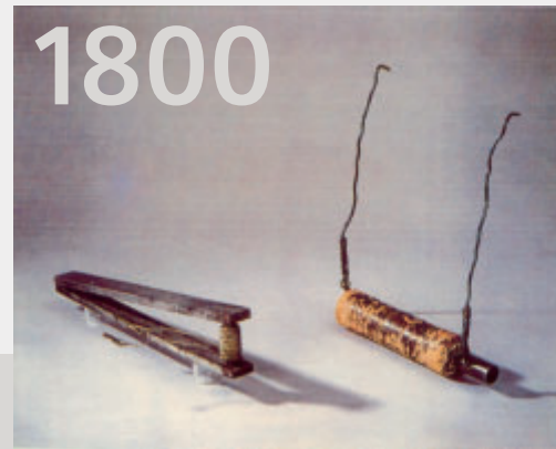
[ 4C ] Faradays Instrumente zum Nachweis der Umwandlung von Magnetismus in Elektrizität
